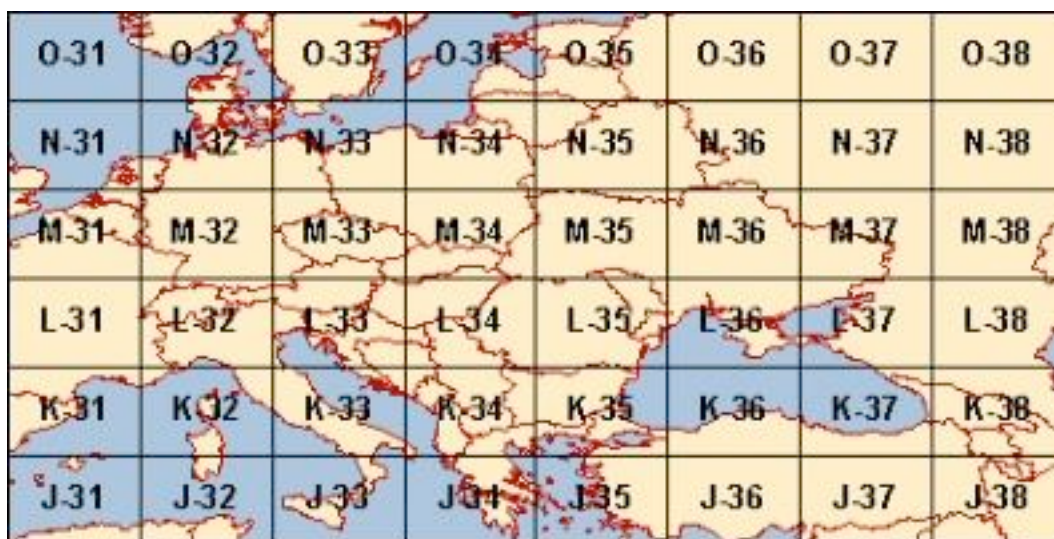
Fig. 8. Fragment de hartă ce prezintă sistemul de împărțire în trapeze egale ( 6^\circ \times 4^\circ ) utilizat pentru harta internațională a lumii, scara 1: 1.000.000.
